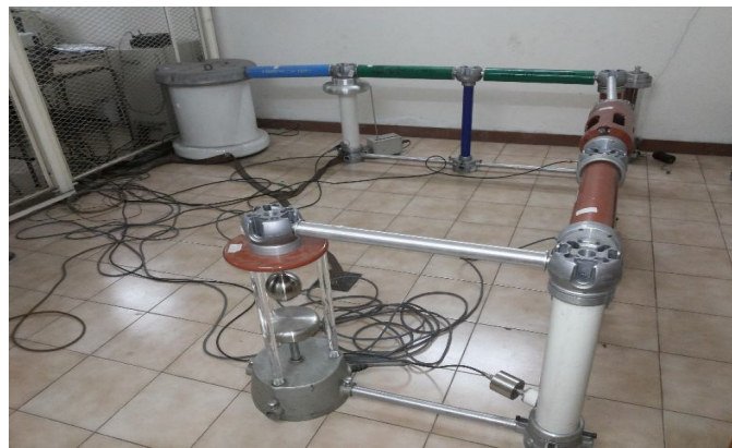
Figura 6: circuito montado para geração e medição de altas tensões impulsivas Fonte: (Autor)
