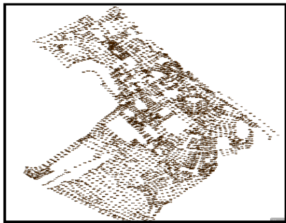
Figure 3 - Nuvem de pontos gerado pela técnica GNSS/RTK e VANT
