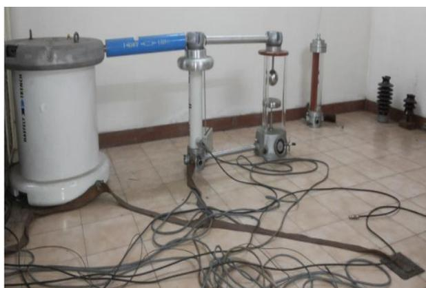
Figura 4: circuito montado para geração e medição de altas tensões alternadas
