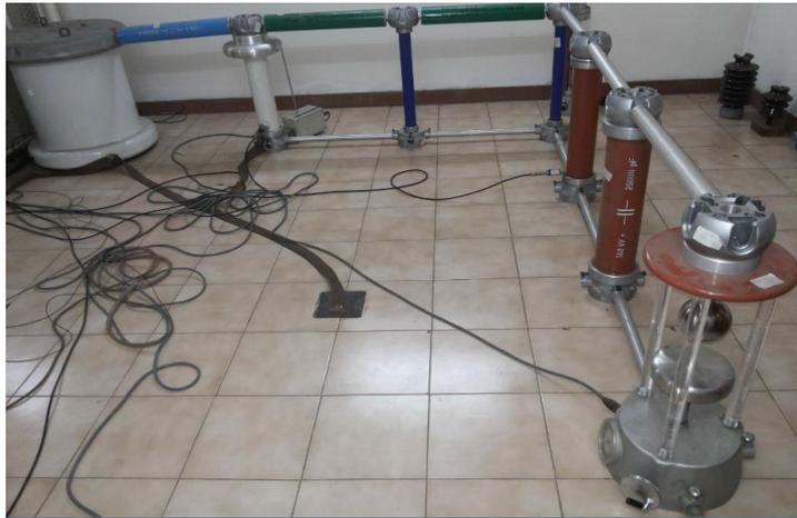
Figura 5: circuito montado para geração e medição de altas tensões contínuas.
