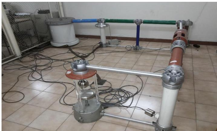
Figura 6: circuito montado para geração e medição de altas tensões impulsivas
